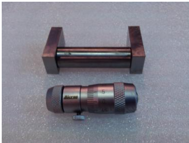
Рисунок 1 - Общий вид микрометрической головки и установочной меры из набора нутромера микрометрического типа НМ.
