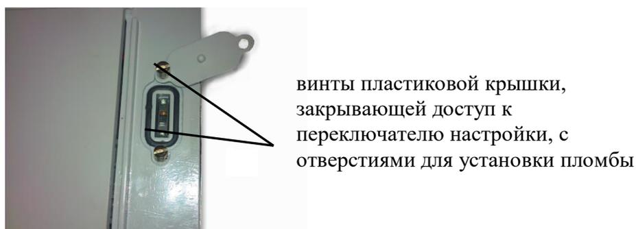
Рисунок 3 - Схема пломбировки весов от несанкционированного доступа.
