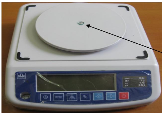
Место нанесения оттиска поверительного клейма - под металлической чашкой грузоприемного устройства
