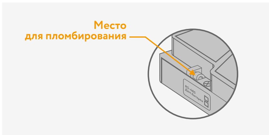
Рис. 1.3 – Место пломбирования инспектором
