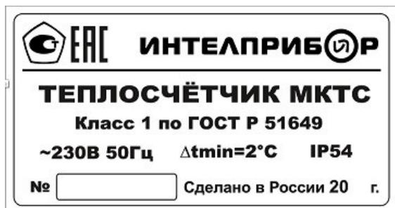
Рисунок 9. Внешний вид таблички с заводским номером для системного блока СБ-04
