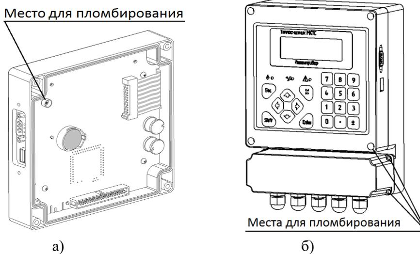
Рисунок 8. Пломбирование системного блока модификации СБ-05
