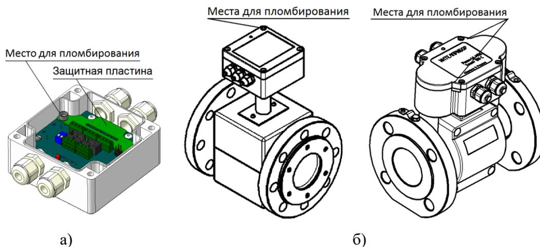
Рисунок 6. Пломбирование измерительных модулей
