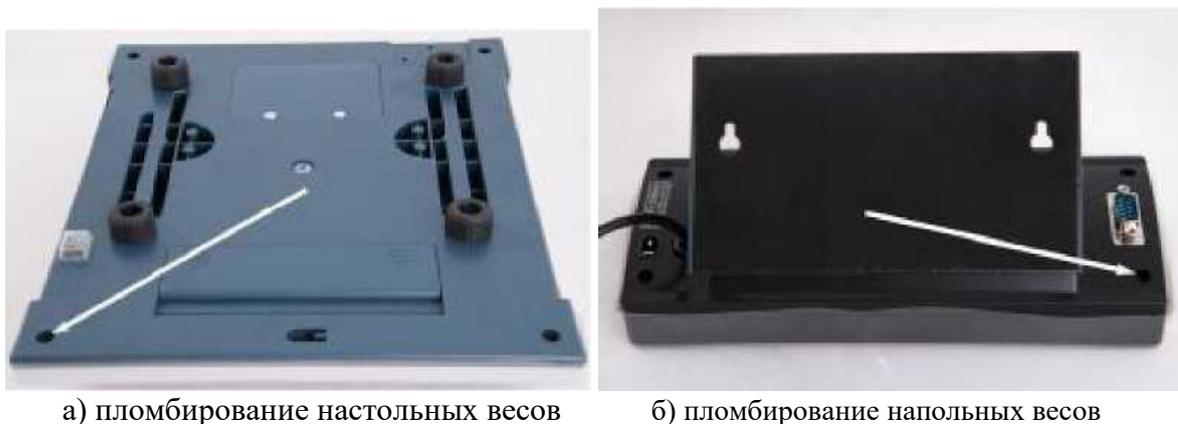
Рисунок 5 - Схема пломбирования весов
