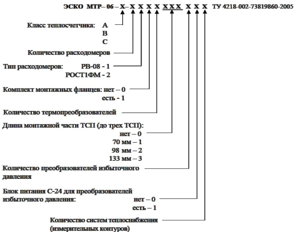
В примере приведено обозначение теплосчетчика:
