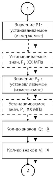
— Способ получения информации о величине избыточного давления теплоносителя в подающем трубопроводе: результат измерений или установленное (запрограммированное значение). Выбор способа получения значения P1 выполняется с помощью кнопок «◀» и «▶». Если выбирается «Значение P1: измеряемое», то следующий пункт меню, выделенный штриховой линией, отсутствует.
