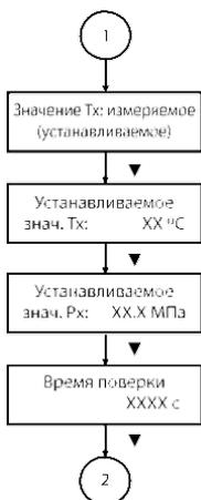
— Способ получения информации о значении температуры холодной воды: результат измерений или установленное (запрограммированное значение). Выбор способа получения значения Tx выполняется с помощью кнопок «◀» и «▶». Если выбирается «Значение Tx: измеряемое», то следующий пункт меню, выделенный штриховой линией, отсутствует.
