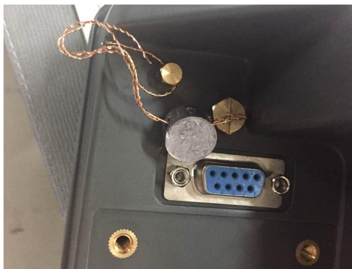
Рисунок 2 - Место пломбировки весов
