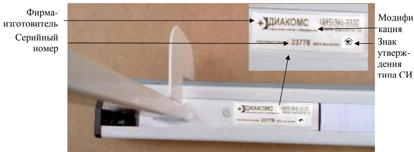
Рисунок 2 - Схема маркировки
