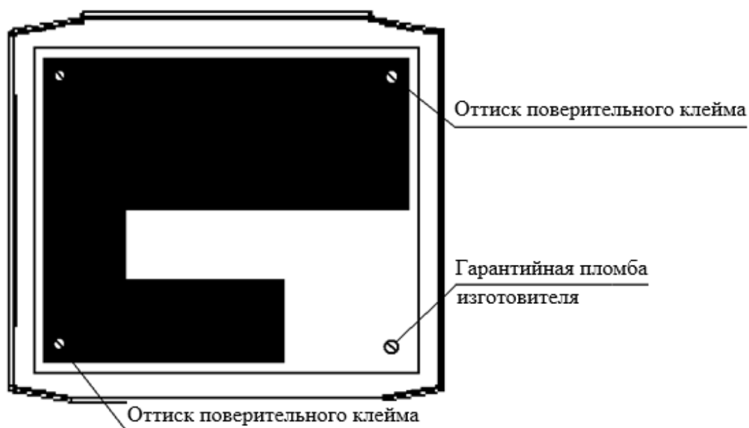
Рисунок 3 - Схема нанесения оттисков поверительных клейм и гарантийных пломб изготовителя на защитную панель вычислителя
